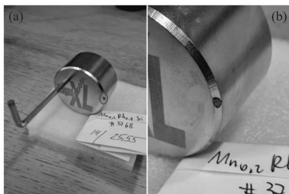
Рис. 7. (Цветной онлайн) Образец \text{Mn}_{0.2}\text{Rh}_{0.8}\text{Si} , удерживаемый постоянным магнитом при комнатной температуре. (а) – Общий вид магнита с образцом (образец отмечен красным кружком). (б) – увеличенное изображение
